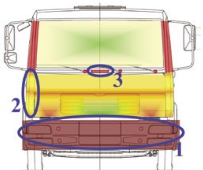
Abb. 2: Visualisierung der Testergebnisse bei 25 km/h
