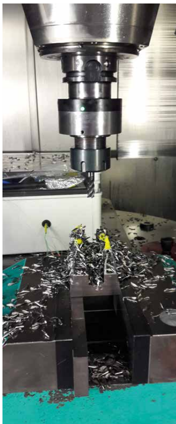
Abbildung 3: Ein Versuch mit Spänen, dem Abfallprodukt beim Fräsen.
