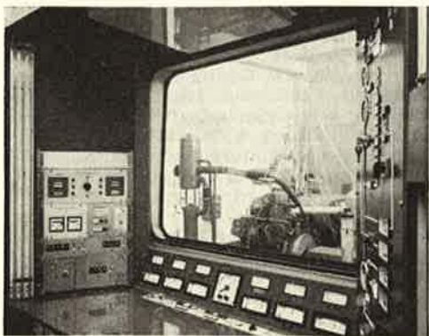
Abb. 1: Automatischer Prüfstand für schnellaufende Motoren
