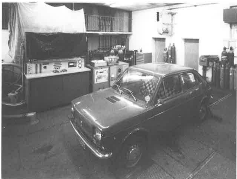
Fahrprüfstand für Kraftfahrzeuge mit Abgasmeßeinrichtungen
