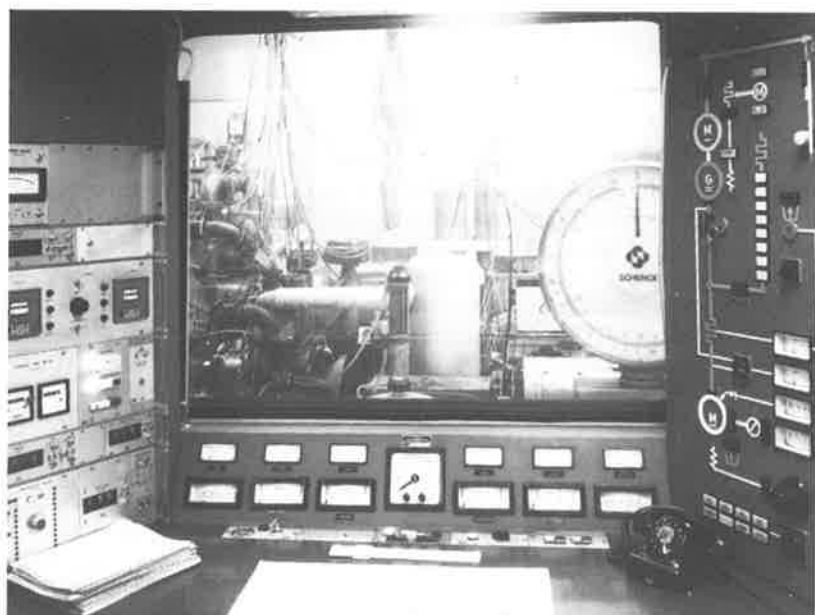
Bedienungs- und Meßpult für einen Motorprüfstand
