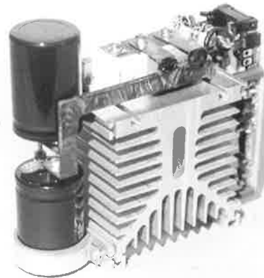
Abb.2: Halbbrücke, bestehend aus Kühlkörper, IGBT Modul, Ansteuerschaltung und Zwischenkreiskondensatoren
