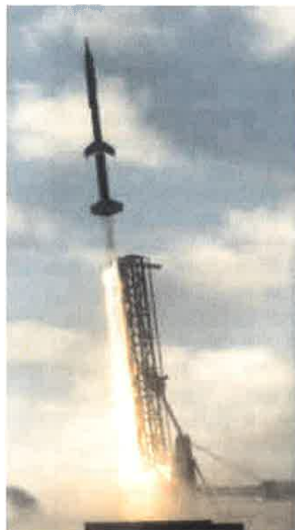
Abb.6: Zweistufige Feststoffrakete unmittelbar nach dem Start
