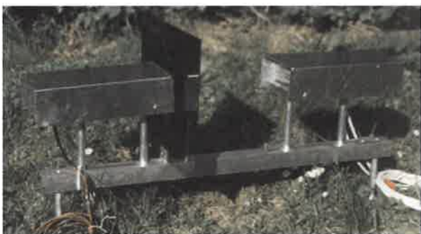
Abb. 5: Optische Übertragungsstrecke zur Niederschlagsbestimmung
