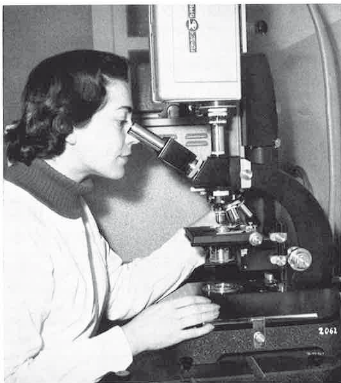
Bild 3 Übertragung mikroskopischer Bilder mittels Fernsehkamera in den Hörsaal
