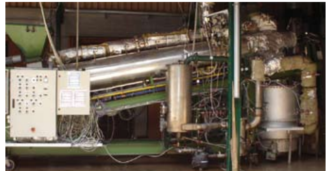
Abb. 2 Versuchsanlage Gestufte Vergasung – IWT (60 kWel)
