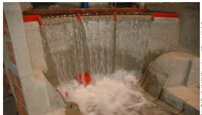
Modell Hochwasserentlastung – Tosbecken
