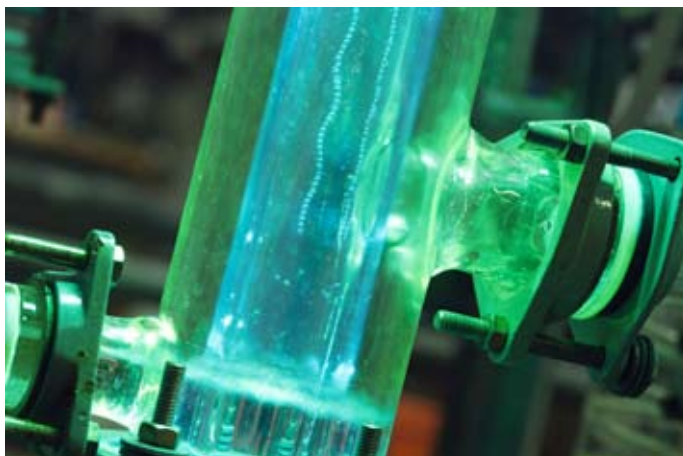
Boden der Fallfilmkolonne im Filmbetrieb bei UV-Bestrahlung
