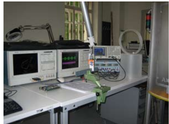
Abb.1: Aufbau und Test von RFID-Lesegeräten, die im Rahmen des FIT-IT Projektes SNAP (Secure NFC Applications) am EMT entstanden sind.
