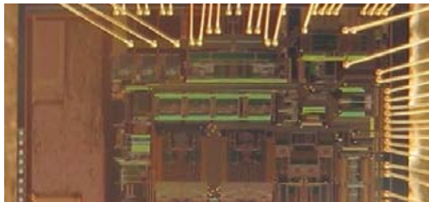
Adaptives Geräuschunterdrückungssystem für PC-Lüfter, Chip-Foto des realisierten Vorschlags aus einem früheren ASIC Wettbewerb (Peter Bliem)
