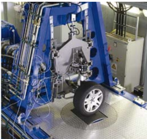
Abb. 1: Dynamischer Bremsen- und Radaufhängungsprüfstand BRP
