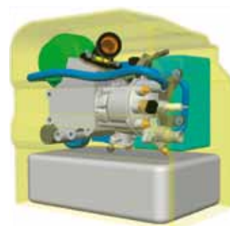
Abb. 1: Einbaustudie für einen Hybrid Scooter mit Range Extender 4 .
