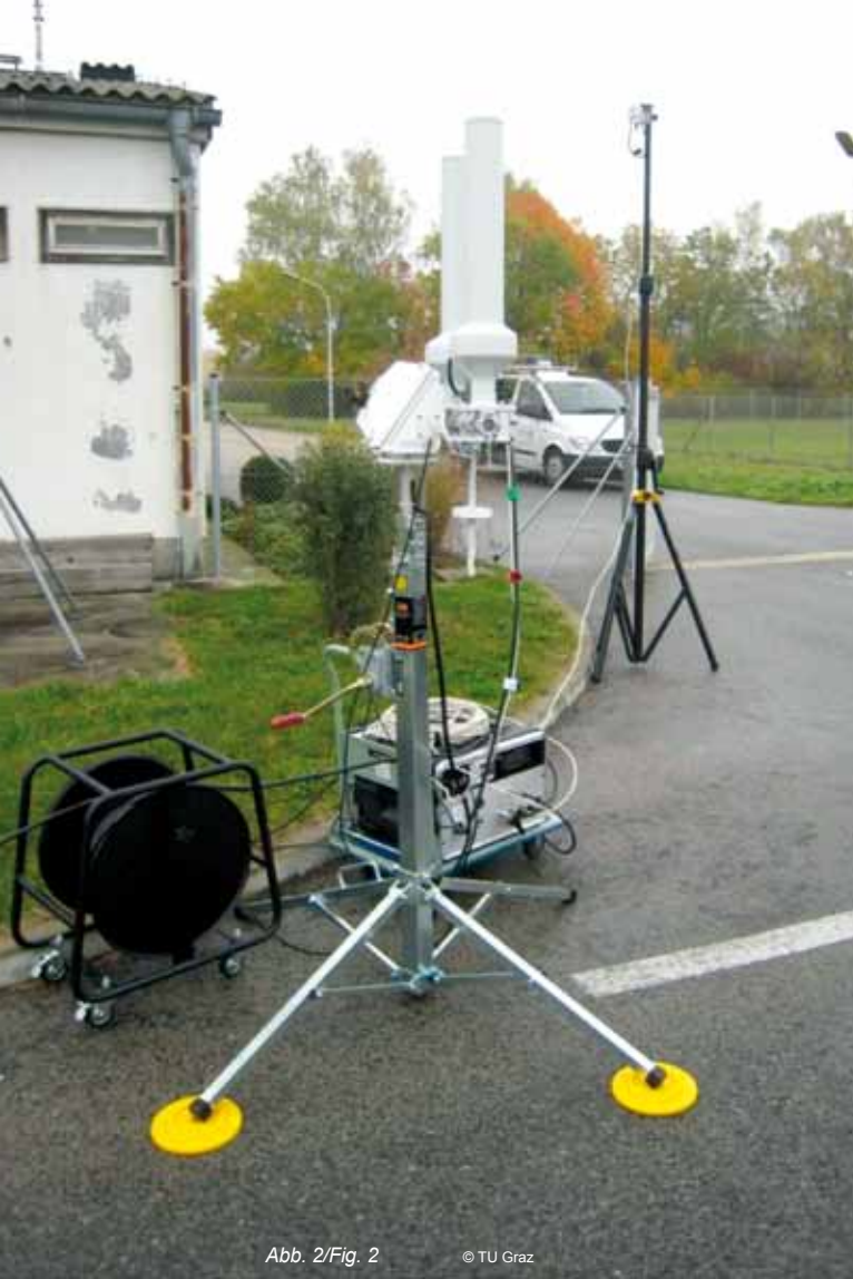
Abb. 2: Bodenstation mit GPS-gesteuerten Richtantennen.
