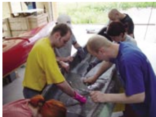
...beim Aufspachteln des Betons
