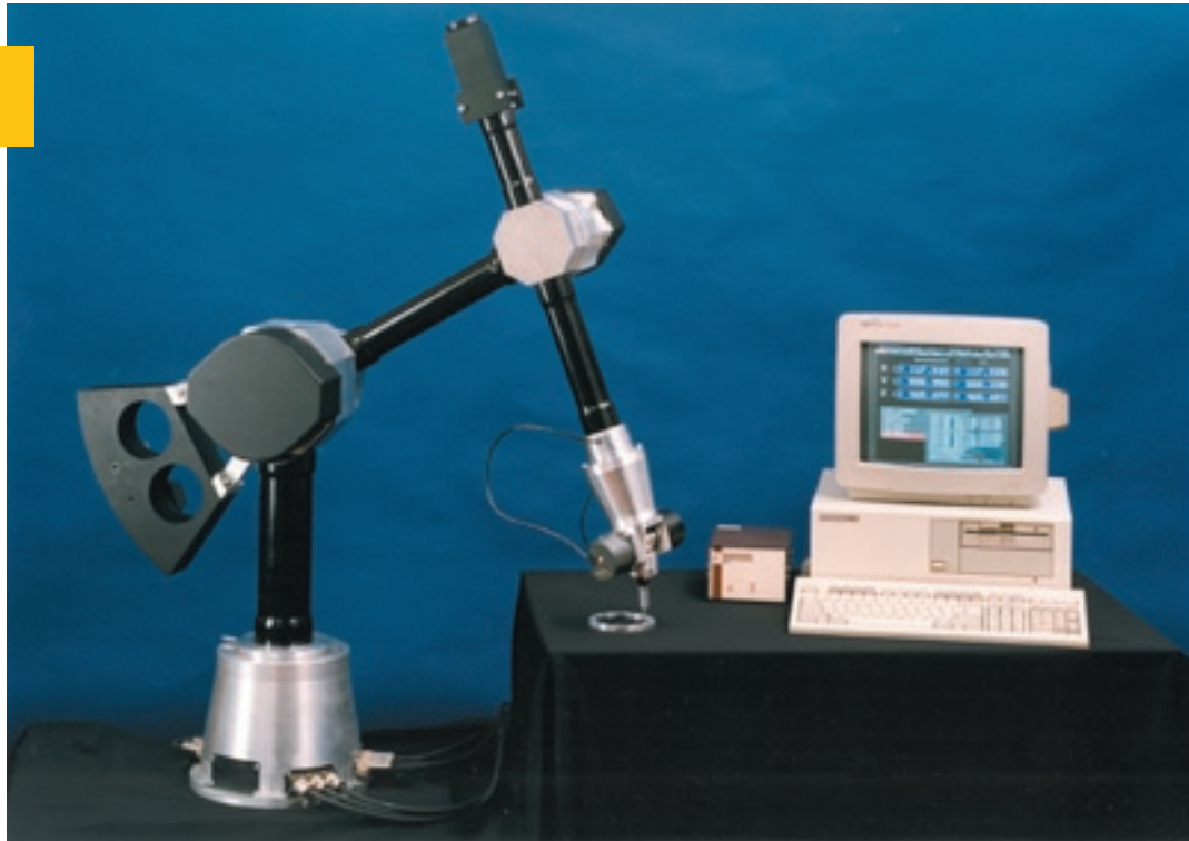
Anthropoidisches Messgerät AMG-1 als mobiler Messarm
