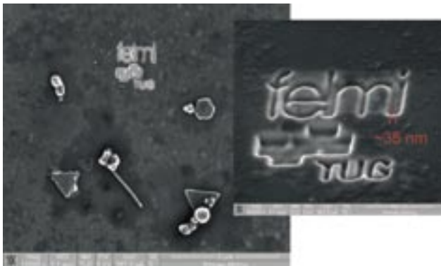
Nanoschrift in Gold-Einkristall neben Gold-Nanoteilchen, eingraviert mit einem fokussierten Ionenstrahl.
