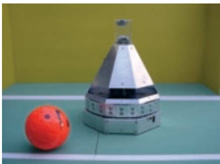
Abb. 6: (a) Autonome Fussballroboter „Keksi“ des Teams der TU Graz für die Roboter-Fussball-Weltmeisterschaft RoboCup. (b) Detail des Bildverarbeitungs-Sensors (360 Grad Panorama). (c) RoboCup Spielfeld im Foyer der Infeldgasse 18.
