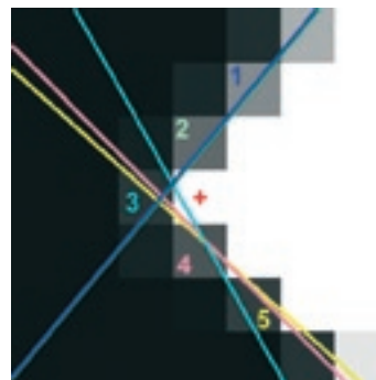
Abb.3: Eine Ecke („corner“) in einem 7x7 Pixel kleinen Bildausschnitt wird subpixel-genau detektiert.
