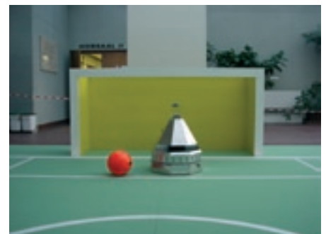
Abb. 6: (a) Autonome Fussballroboter „Keksi“ des Teams der TU Graz für die Roboter-Fussball-Weltmeisterschaft RoboCup. (b) Detail des Bildverarbeitungs-Sensors (360 Grad Panorama). (c) RoboCup Spielfeld im Foyer der Infeldgasse 18.
