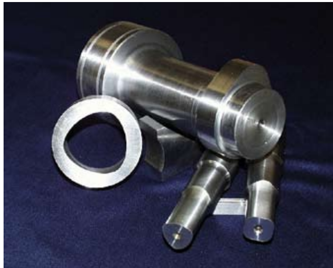
Polygonprofile und Nockenwelle. Geschliffen am IFT der TU Graz mit dem CNC-Unrundschleifprogramm Kelpoly
