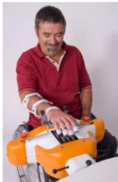
Hier sieht man Amadeo in Aktion: Die Finger sind mit dem System verbunden, der Unterarm und die Hand werden zum System positioniert
